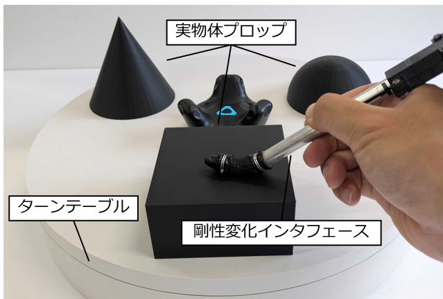
図 1 ターンテーブルに設置された実物体プロップと剛性変化インタフェース (Transtiff) から構成される TouchMorph の外観
